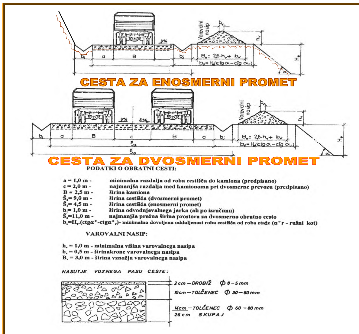
Skica: Prečni presek enosmerne dvosmerne ceste z osnovnimi elementi vozišča
